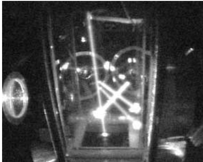
Abbildung 3.22.: 'Auf den Punkt gebracht': die Strahlen galten vor dem Verschieben der Grundplatte als justiert auf einen gemeinsamen Punkt... Eine Nachjustage mit Rb-Fluoreszenz ist nötig!
